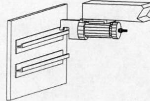
2. AT THE END OF THE LINE OF RIVETS, THE FLYING HEIGHT AND EDGE DISTANCE TRACERS ARE TURNED OFF, AND A G98 MACHINE RELOCATION IS PERFORMED TO PREPARE FOR THE STRINGER JUMP.
